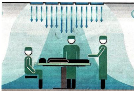
L'impianto a flusso unidirezionale installato a Torrette e, sotto, la modalità di funzionamento
